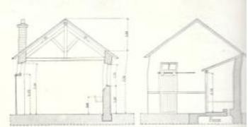
Fig. 107 (dét. n° 103 p. m.). — Coupe sur un bâtiment abattoir.
